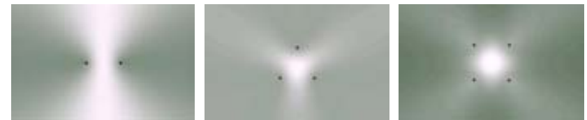
Рис.45 Картина распределения энергии: а – диполь; б – треугольник; в – квадрат. На рис.45в видно, что осцилляторы находятся в зонах неустойчивого равновесия
