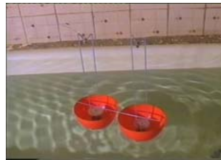
Рис.100 Перемещение системы происходит в среде и обеспечивается сдвигом фаз между колебаниями источников.
