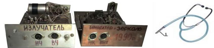
Рис.29 Фотографии задающего генератора, имитатора зеркала, а также, фонендоскопа, где 1 – тонкая медная трубка для поиска узла стоячей волны.
